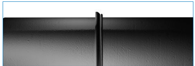
Slechte spiegelllas verbinding: ongelijke opwarming
