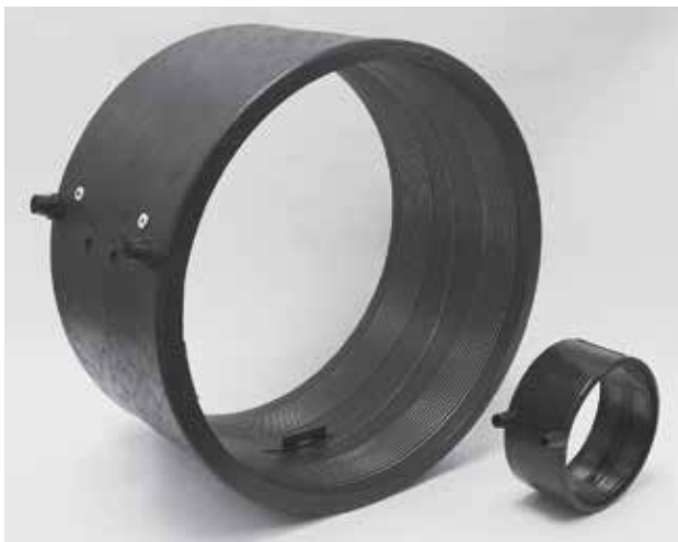
Elektrolasmof als overschuifmof: in de diameters 40 mm tot en met 160 mm stootrand verwijderen met een mesje. In de diameters 200 mm tot en met 315 mm: stootrand verwijderen met schroevendraaier.
