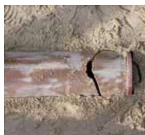
Gres buizen overleefden geen enkele test.
