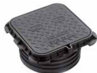
KIO Composietdeksel met kraag B125 400x400mm tbv ø315mm 20049439 500x500mm tbv ø400mm 20049440 700x700mm tbv ø630mm 20044941
