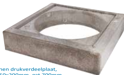
Betonnen drukverdeelplaat, 900x900x200mm, gat 650mm, tbv PE put 630mm of telescoopdeel Axedo/Dykamax 20034169
