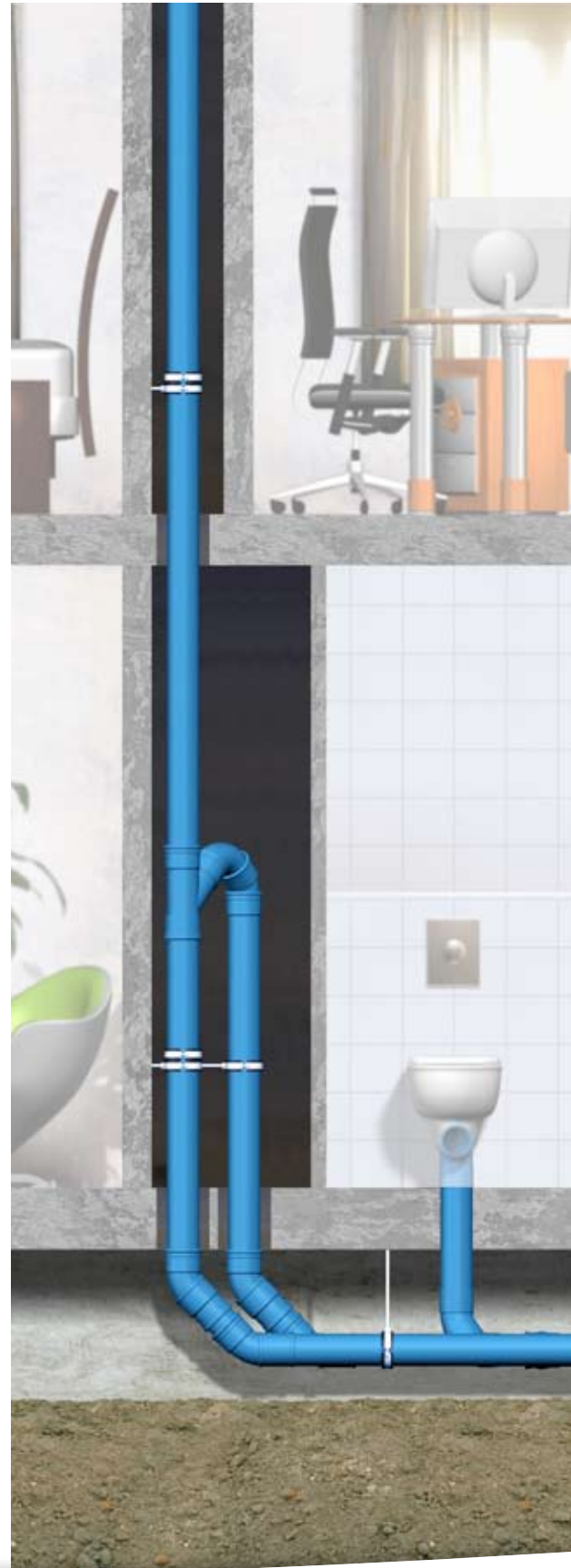
Montage standleiding in schacht met shunt t.b.v. toilet.
