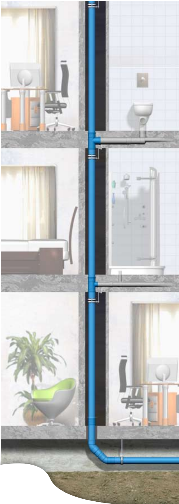
Montage standleiding in schacht met dubbel vastpunt beugels aan plafond.
