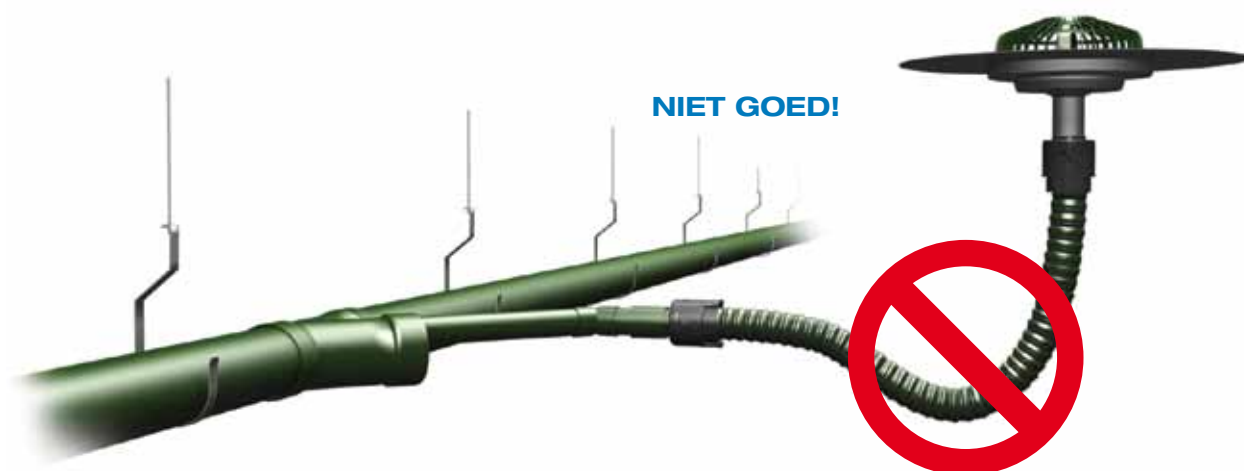
Figuur 6.2: slang mag niet doorhangen
