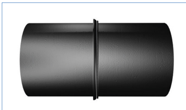
Nieprawidłowe połączenie, rury zostały nierównomiernie podgrzane
