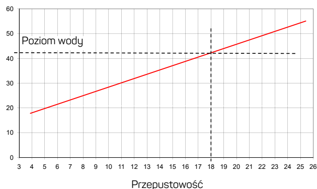
Wykres 1.3: Przy słupie wody 43 mm wpust o średnicy 75 mm osiąga przepustowość 18 l/s
