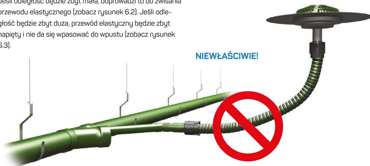
Rysunek 6.3: Nie należy mocować naprężonego przewodu
