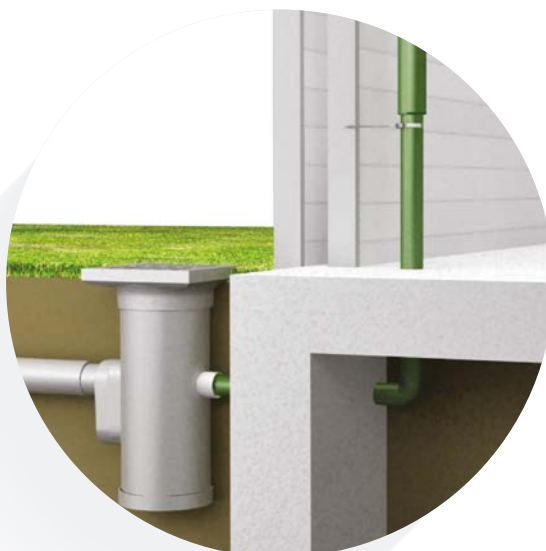
Rysunek 2.4: Przykład podłączenia rury Vacurain o średnicy powyżej 90 mm.
