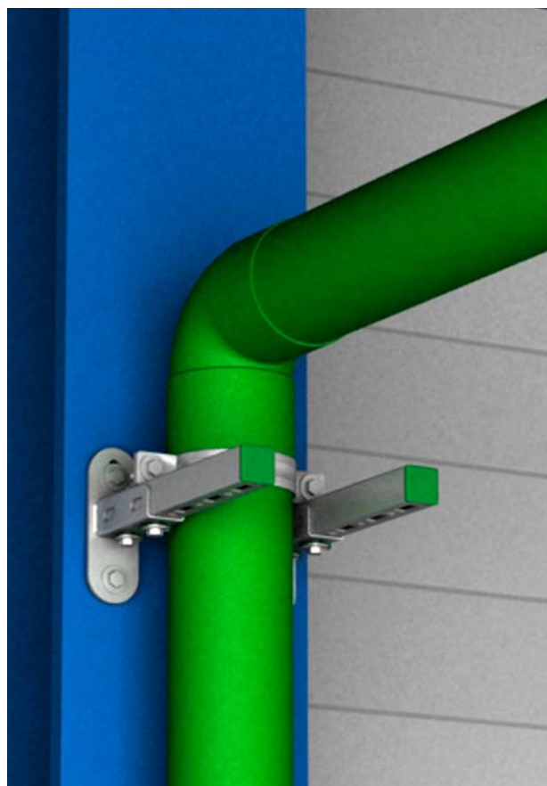
Rysunek 6.9: Przykładowy punkt konstrukcyjny bezpośrednio pod kolanem 90°
