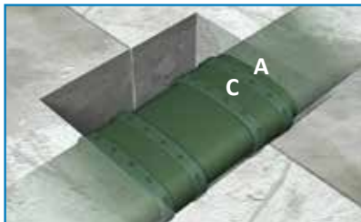
Stap 8 Schuif de andere schuifmof (C) over het andere spie-eind. (Wanneer de markeringslijnen nog zichtbaar zijn, is de verbinding niet luchtdicht)
