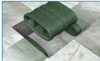
Stap 6 Laat het passtuk zakken in de sparing. (Smeer evt extra glijmiddel op de rubber manchetten voor een gemakkelijke montage.)
