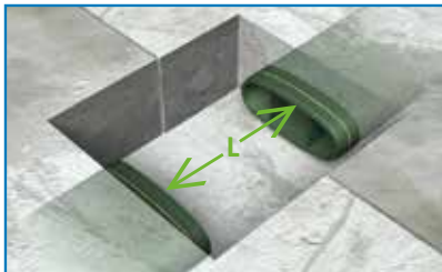
Stap 4 Meet de benodigde lengte (L) voor het passtuk op en zaag het passtuk op lengte. Ontbraam het passtuk buis en schuin deze aan voor een gemakkelijke montage.
