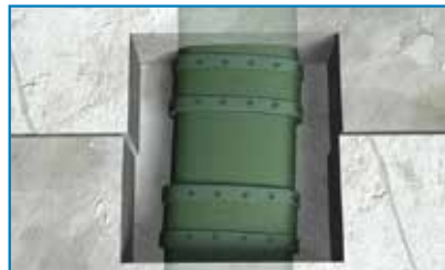
Stap 9 Hiermee kunnen ook kleine uitlijningsverschillen overbruggen worden, zowel in de breedte als in de hoogte.
